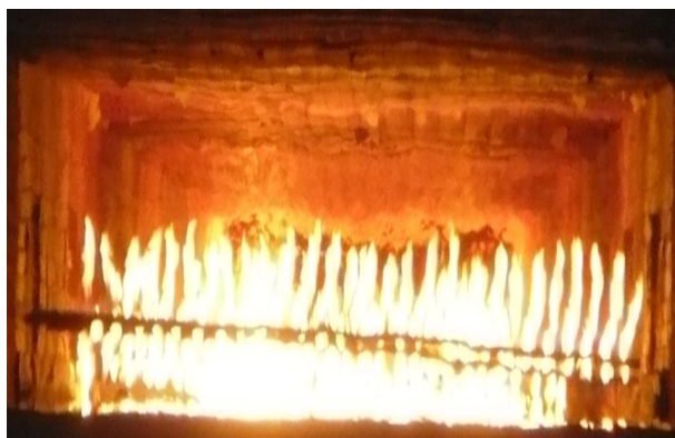
Rys. 6 Widok pieca z tyłu. Rozpalanie lancami.
