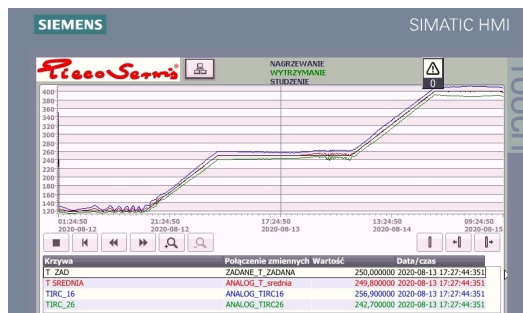
Wieloodcinkowa krzywa procesu – faza nagrzewania i wytrzymania
