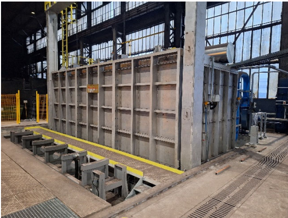
Rys.4 Widok pieca komorowego ze stałym trzonem – front, pole odkładcze magazynu
