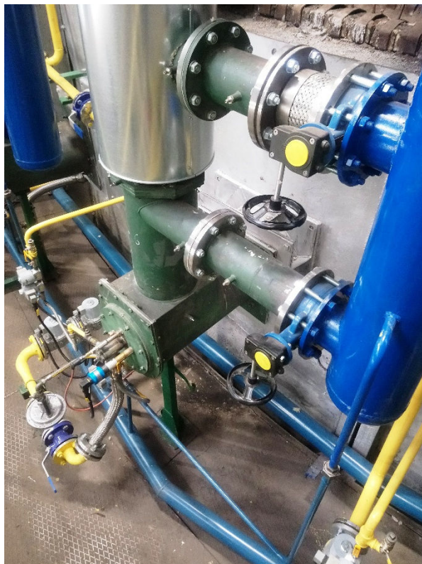
Rys. 3. Palnik rekuperacyjny RPG-600 pieca z obrotowym trzonem o średnicy podziałowej 13,6 m po modernizacji w 2019r.
