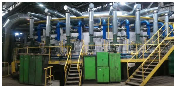
Rys. 5. System grzewczy pieca z obrotowym trzonem o średnicy podziałowej 13,6 m po modernizacji w 2019r.
